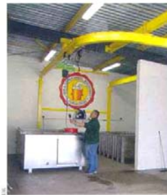
◀ Appareil de levage pour transfert des produits décapés jusqu'à la cuve de lavage.
