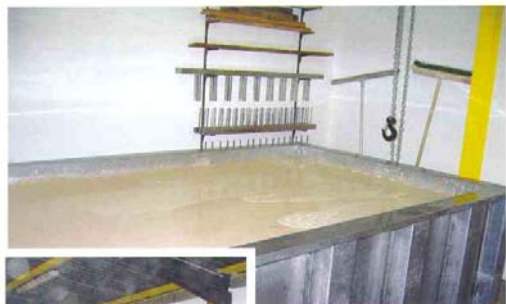
▲ Cuve de 10 m 3 remplie de produit pour le décapage des pièces.
